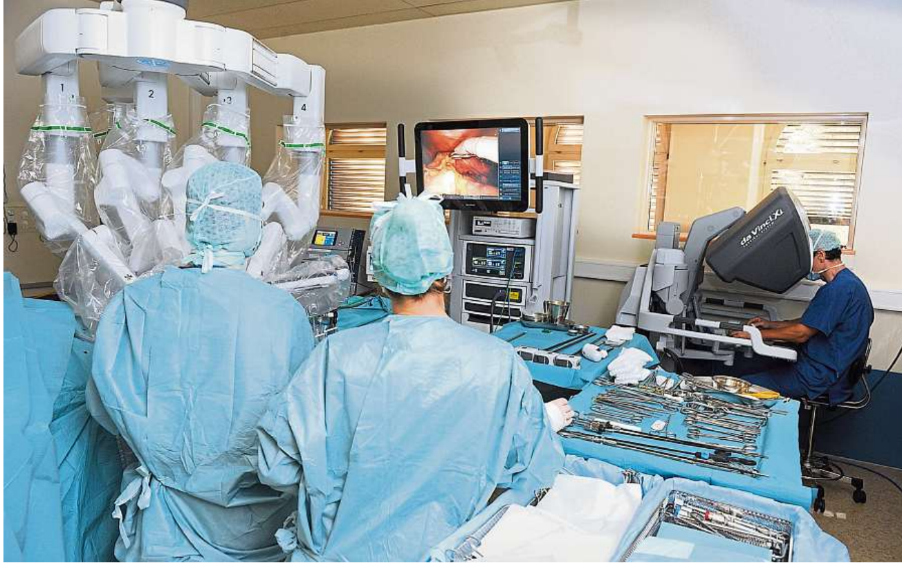
Vierarmiges Wunder der Technik. Der Blick des Chirurgen ruht nicht auf dem Operationstisch, sondern auf einem Bildschirm. Mit seinen Händen steuert er den Roboter. Jede Bewegung wird an die Arme des Computers weitergeleitet.
